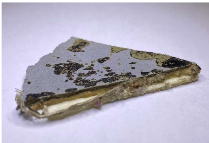
Ovan: Golvpatta med svartlim. Höger: Asbestfibrer av sorten antofyllit påträffades i limmet.
