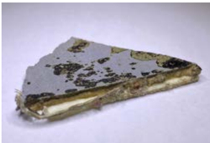
Ovan: Golvplatta med svartlim. Höger: Asbestfibrer av sorten antofyllit påträffades i limmet.
